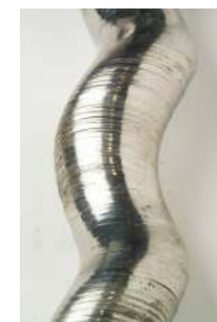
Nachbau: Rotor aus unbekanntem Metall mit starker Abnutzung und schlechtem Wirkungsgrad
